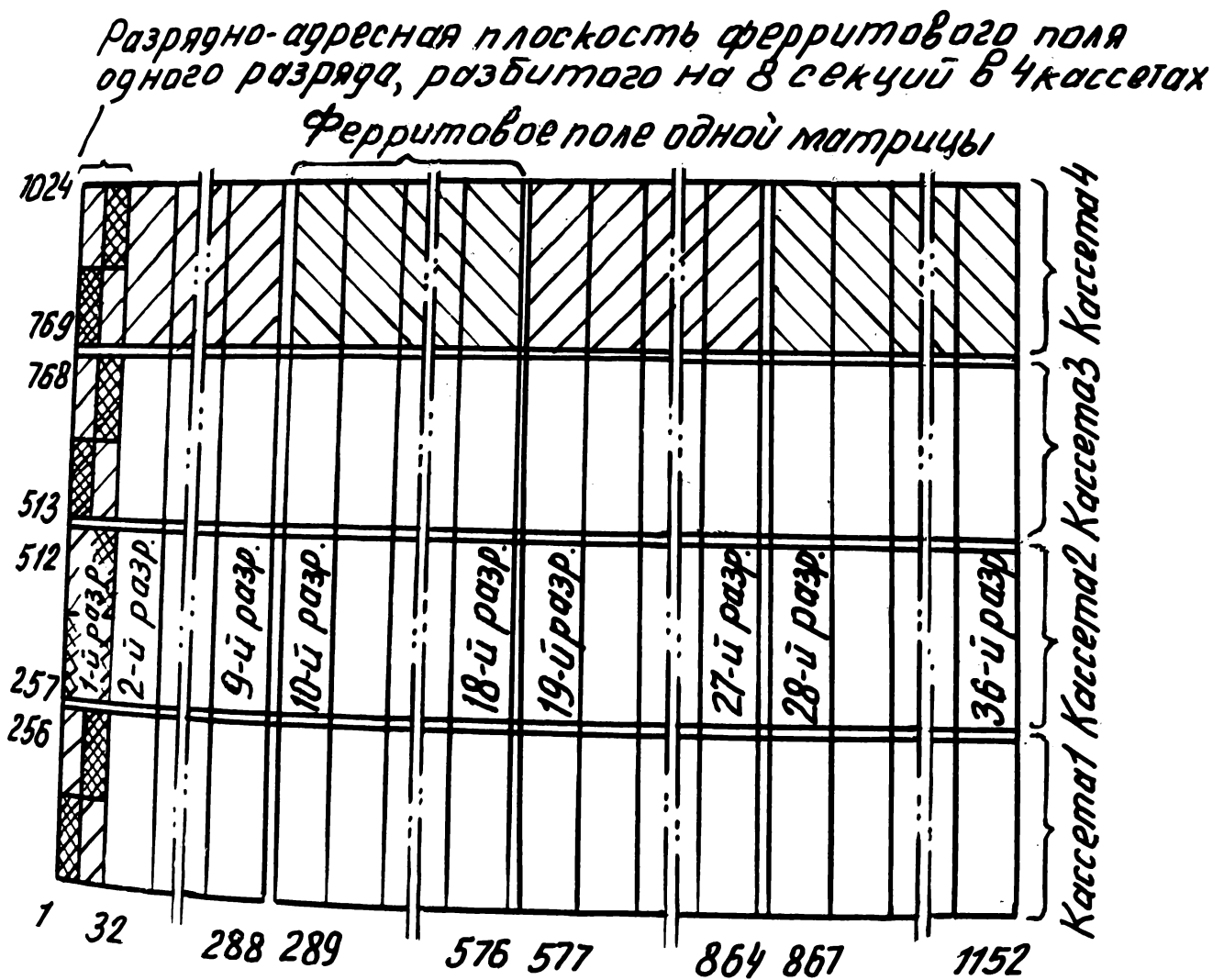
Рис.2. Поле элементов магнитного блока 32К 36 разрядов и его деление по кассетам и матрицам
