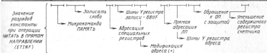
Рис. 5.21. Содержимое регистра микрокоманд GRC при разделенных циклах
