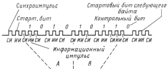
Рис. 7.8. Представление байта информации по методу двойной частоты
