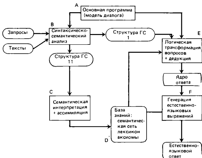
Рис. 1. Структура и принцип действия вопросно-ответной системы FAS-80
