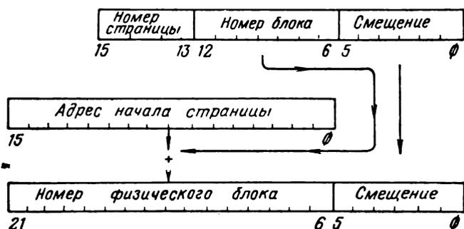
Рис. 16. Схема формирования физического адреса ДП
