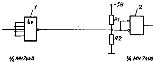
Рис. 56. Электрическая схема реализации линий связи ИФМД-2: 1 — передатчик; 2 — приемник
